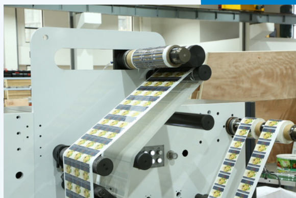
Zbierak odpadów typu „snowball”, odpowiedni do etykiet o różnych kształtach.
